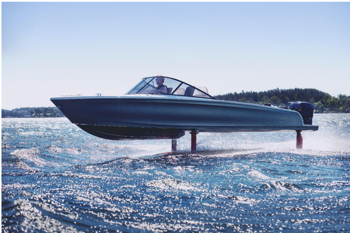
Figur 21. Candela Seven svävar fram på bärplansteknik [1].
