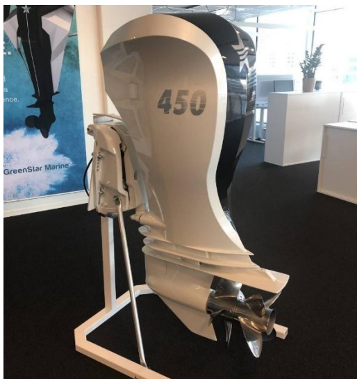
Figur 20. Utombordsmotor med eldrift från GreenStar Marine [22].
