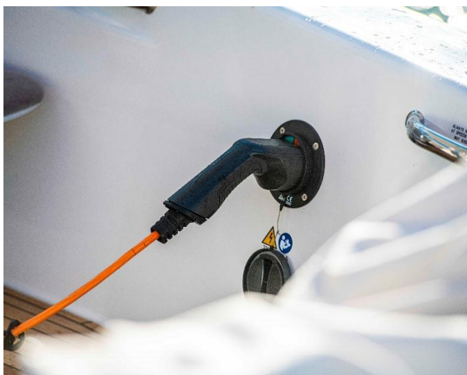
Figur 16. Pågående laddning av elbåt med kontaktdon typ 2 [1].
