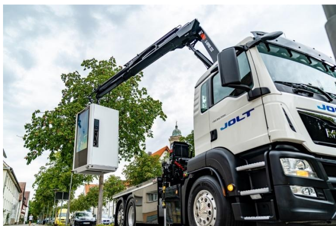
Figur 24. Snabbladdare med batterilager från JOLT Energy som kan flyttas runt efter behov [25].
