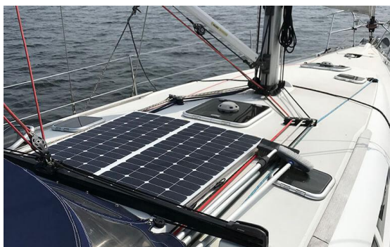
Figur 26. Fasta solceller med cirka 250 W/m 2 och bärbar solcell med cirka 175 W/m 2 [29].
